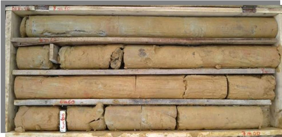
**Echantillonnage en sondage carotté**
