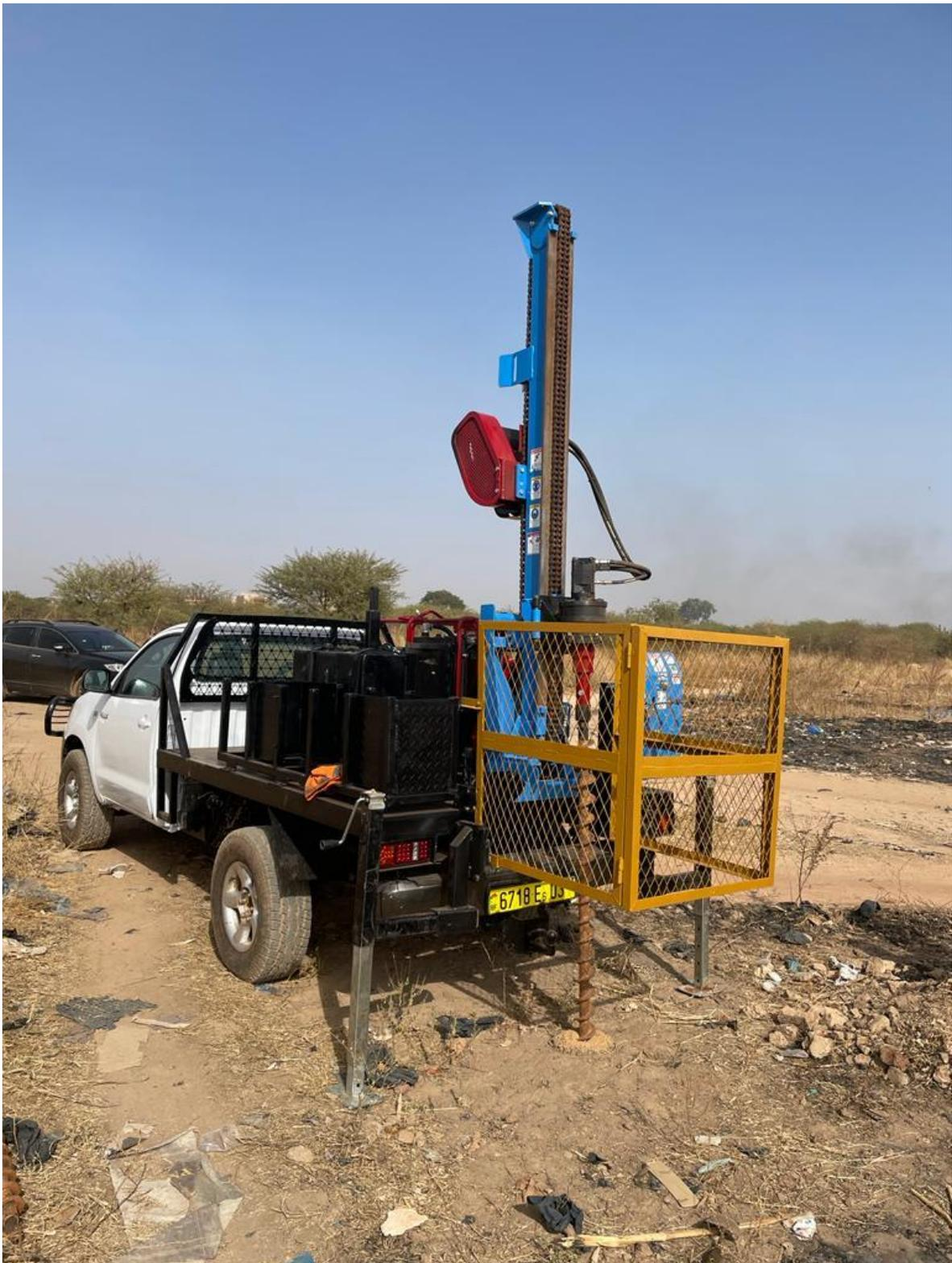
**Machine sondeuse sur Pickup 4X4**
