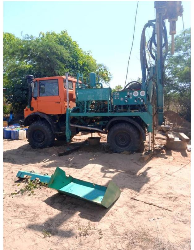
**Foreuse de marque UNIMOG Capacité 250 m**
