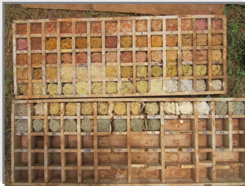
**Echantillonnage pour Forage d'eau**
