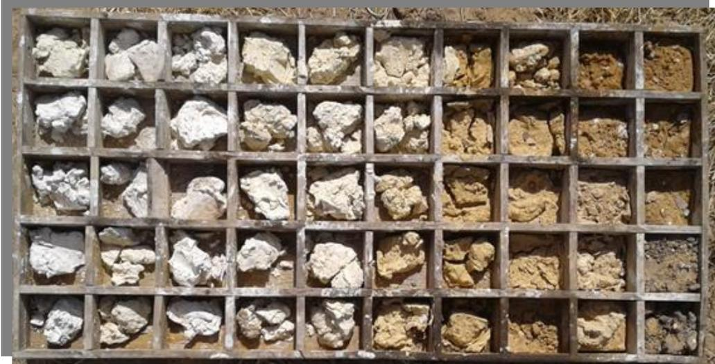
**Echantillonnage en sondage destructif à la boue**
