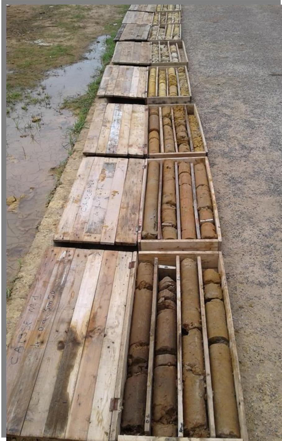
**Echantillonnage en sondage carotté**
