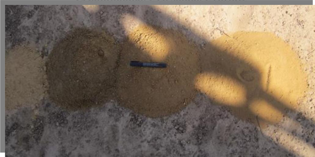
**carotté Echantillonnage en sondage destructif à l'air (RAB ou RC)**
